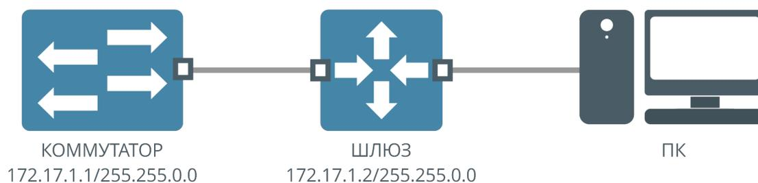
Рисунок 4. Подключение ПК к коммутатору через шлюз
