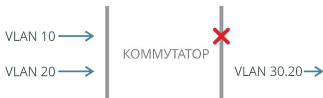
Рисунок 26. Схема работы Egress Filter
