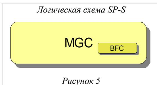
Основное предназначение MGC прием и разбор сигнализаций по протоколу SIGTRAN, связь с SP-S и отдачи команды MG.
