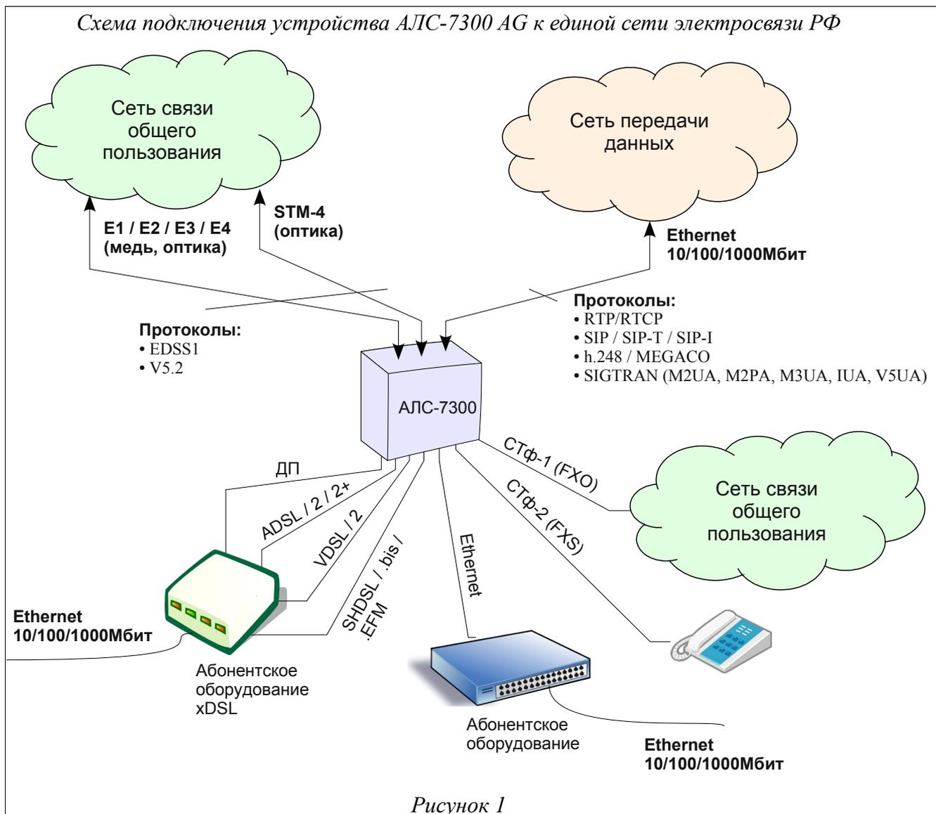
Помещение, в котором устанавливается АЛС-7300 AG, должно быть чистым и хорошо вентилируемым. Для работы устройства необходим блок БУН-21/6, который устанавливается в стандартную 19” стойку и занимает по высоте 6U. Устройство работает от источника питания с напряжением 36 - 72 В.
