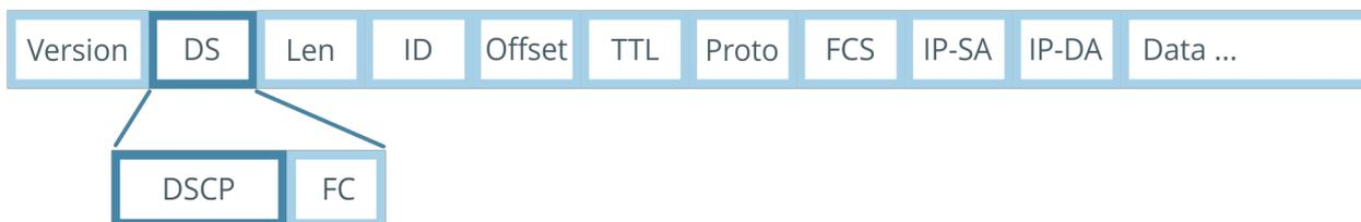
Рисунок 62. Положение метки DSCP в заголовке IP-пакета
