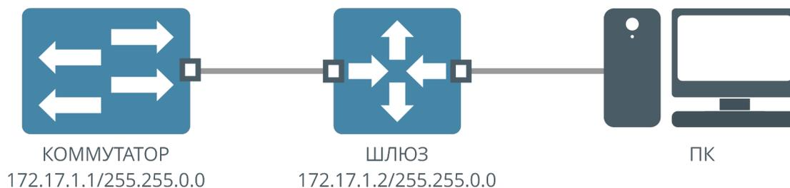
Рисунок 4. Подключение ПК к коммутатору через шлюз
