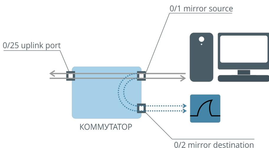
Рисунок 15. Механизм зеркалирования
