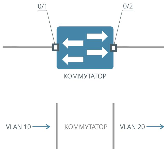
Рисунок 22. Схема работы входной трансляции
