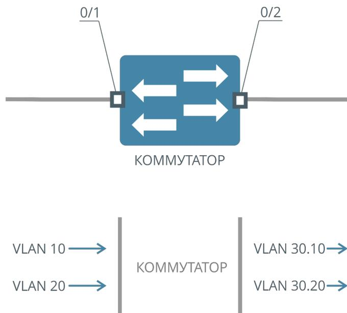
Рисунок 24. Схема добавления S-VLAN по порту (Port-based Q-in-Q)
