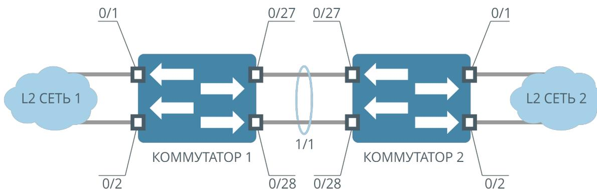
Рисунок 14. Пример агрегации каналов для двух L2-сетей
