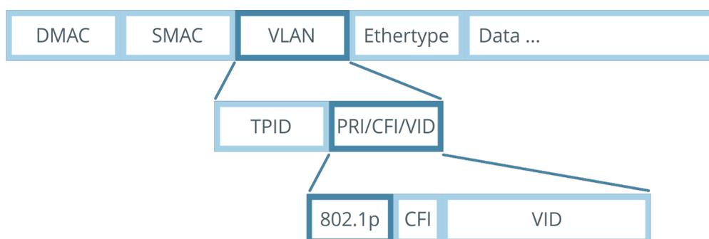
Рисунок 61. Положение метки 802.1p в теге 802.1q
