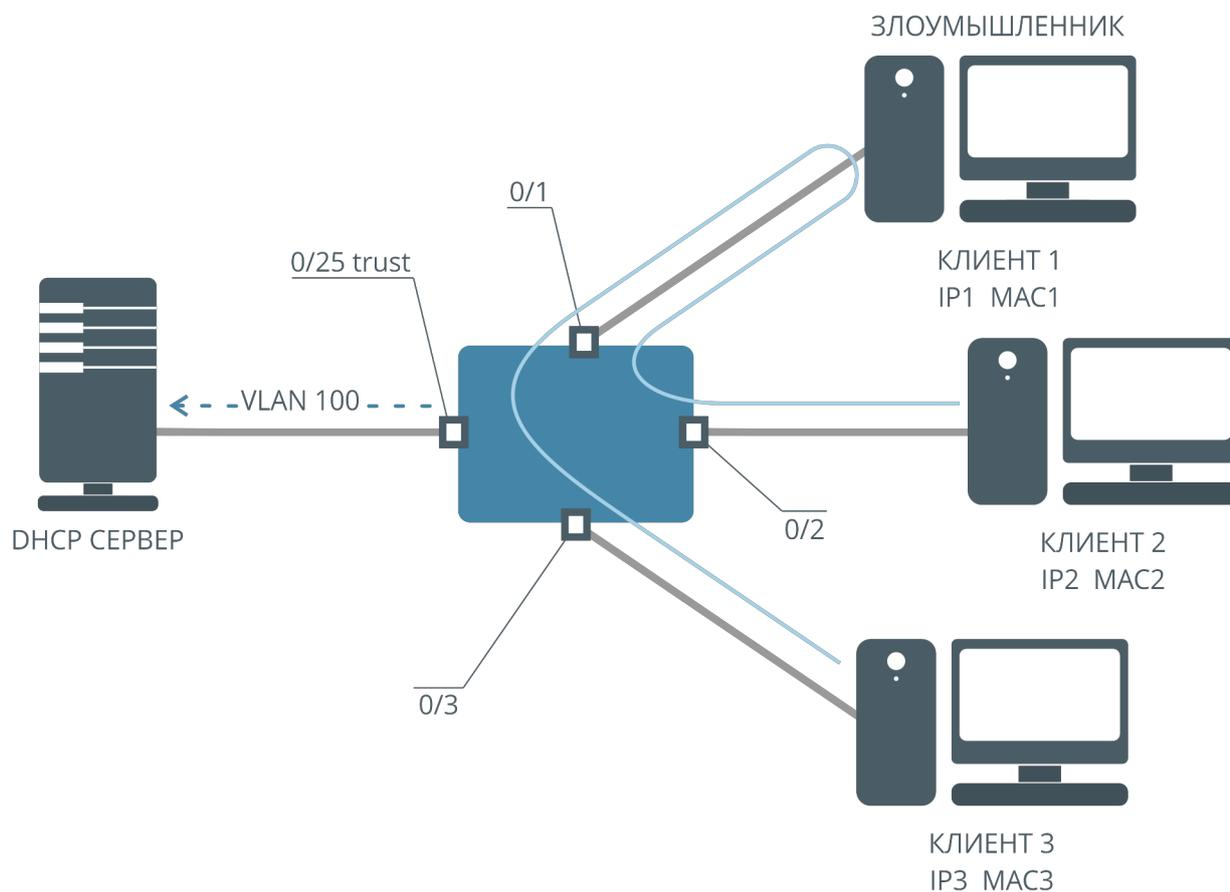
Рисунок 59. Упрощенная схема атаки с подменой MAC-адресов
