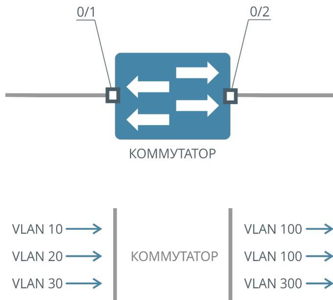
Рисунок 27. Схема работы выходной трансляции
