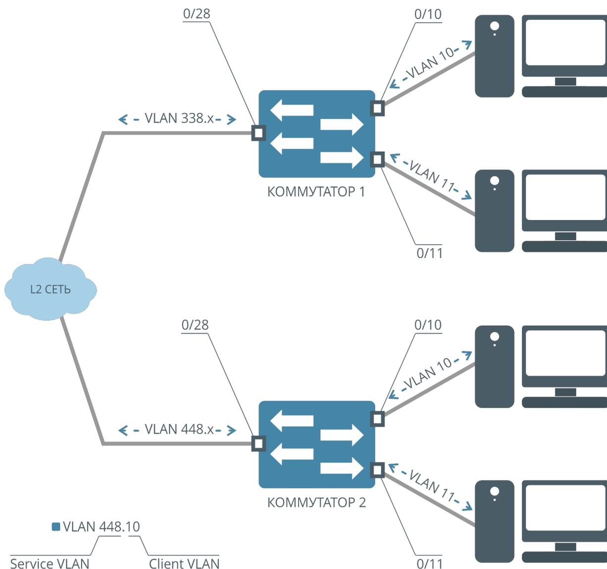
Рисунок 21. Схема предоставления услуг с использованием Double VLAN
