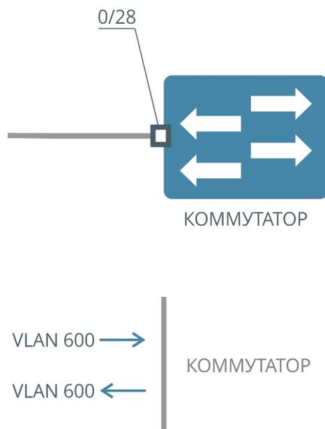
Рисунок 30. Схема прохождения управляющих пакетов во VLAN 600
