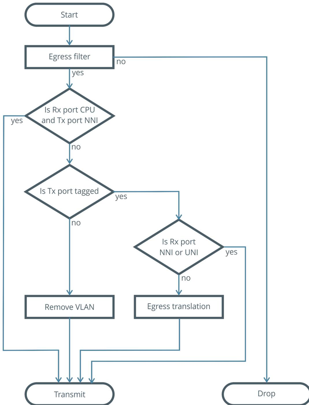
Рисунок 29. Схема обработки пакета на выходе интерфейса
