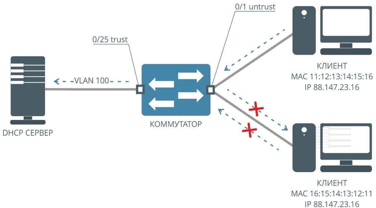
Рисунок 58. Схема работы DHCP IP Source Guard
