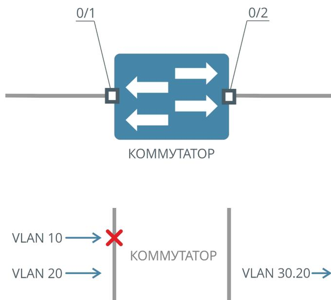
Рисунок 25. Схема работы Ingress Filter
