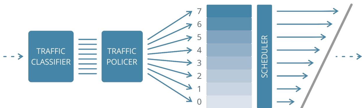
Рисунок 63. Механизм работы QoS на коммутаторах АЛСиТЕК
