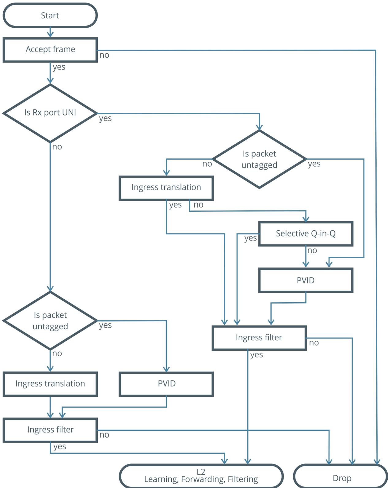
Рисунок 28. Схема обработки пакета на входе интерфейса
