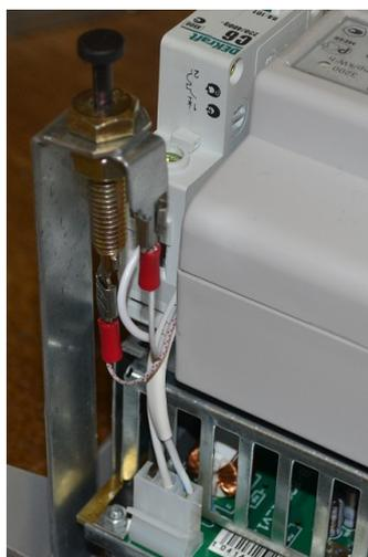
Рис.5 Датчик вскрытия в версии АЛС-24100LVT v.1.0
