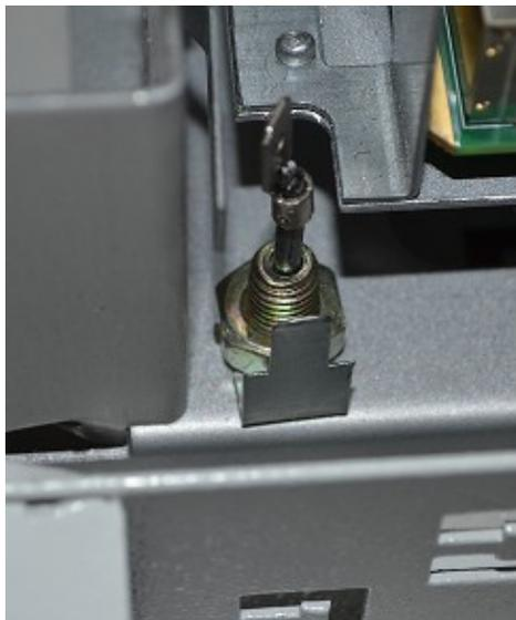
Рис.8 Датчик отрыва в версии АЛС-24100LVT v.2.0
