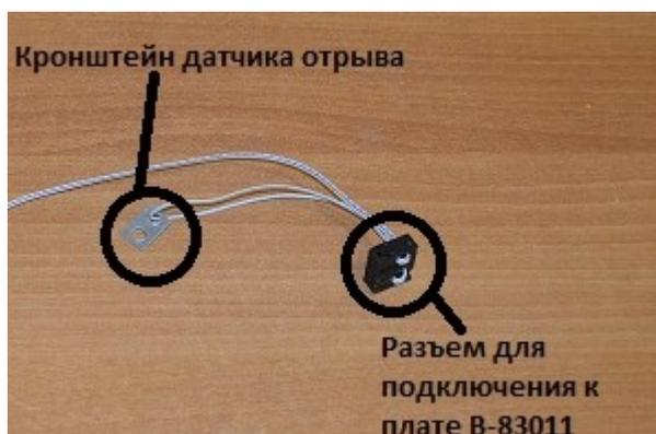
Рис 4. Датчик отрыва в версии АЛС-24100LVT v.1.0
