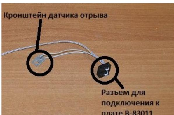
Рис 6. Датчик отрыва в версии АЛС-24100LVT v.1.1
