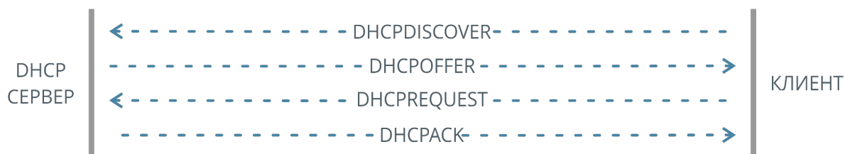
Рисунок 55. Типовой процесс получения сетевых настроек по протоколу DHCP
